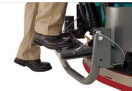
Escalón de acceso al depósito de recuperación
